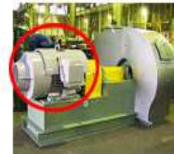
送風機(工場内の集塵等)
