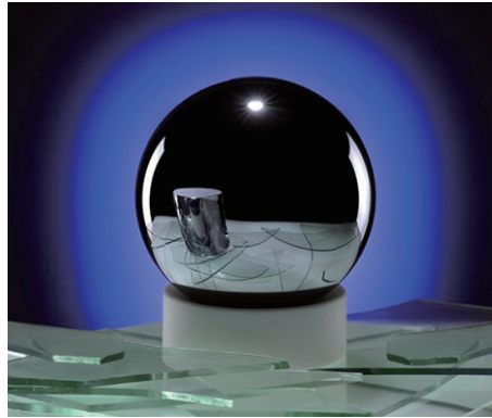
高度な研磨シリコン単結晶球の原子数を計測
