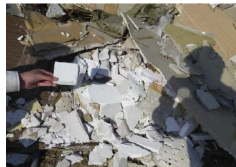
廃建材集積場に混じるスレートボード
